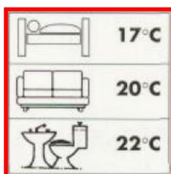
**1.3. Richtiges Lüften und Raumtemperatur.** Senken Sie die Raumtemperatur nicht übermässig und ohne Überprüfung der Isolationsqualität der Gebäudehülle (ältere Bauten) unverhältnismässige Energiesparbemühungen können zu Kondenswasserschäden und zu hygienischen Problemen (Schimmelpilzbildung) führen. Bleiben Sie in den Wohnräumen bei einer Temperatur von ca. 20°C.
